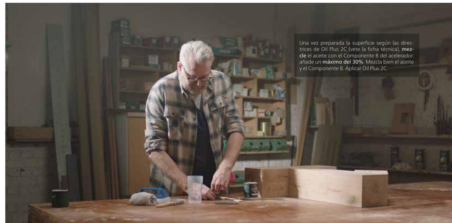
Una vez preparada la superficie según las directrices de Oil Plus 2C (vete la ficha técnica), **mezcle** el aceite con el Componente B del acelerador: añade un **máximo del 30%**. Mezcla bien el aceite y el Componente B. Aplicar Oil Plus 2C.
