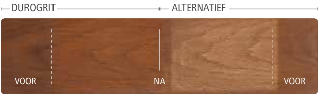
De kleur Foxy Brown op teak , getest op uv-bescherming na 5 jaar tegen een alternatief dat een tweelagensysteem gebruikt.
