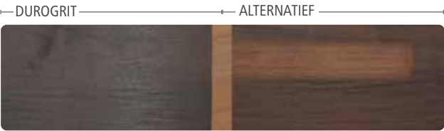
Het resultaat van de houten plank na de scrubtest . Zoals je kan zien, is de plaats waar de borstel overheen bewoog erg zichtbaar bij het alternatief product, terwijl dit bijna onzichtbaar is bij DuroGrit.
