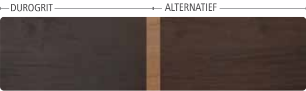
De houten plank voor de scrubtest . Links werd de DuroGrit-kleur Charred Black aangebracht en rechts een vergelijkbare kleur van een alternatief product.
