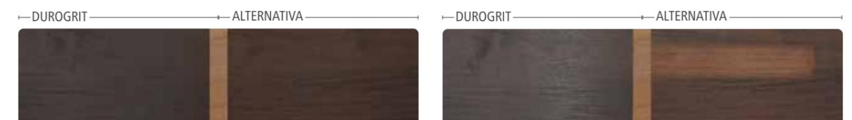
Il campione di legno prima della prova di sfregamento. È stato trattato con DuroGrit colore Charred Black a sinistra e con un prodotto alternativo di colore simile a destra.
