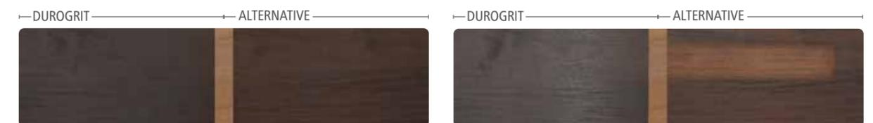
L'échantillon en bois **avant le test de frottement**. Il a été traité avec la couleur **DuroGrit Charred Black** sur la gauche et avec un produit alternatif de couleur similaire sur la droite.
