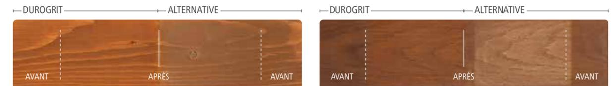
Test de la protection aux UV après 5 ans de la couleur **Foxy Brown** sur le **pin** comparé au produit alternatif en deux couches.
