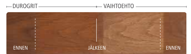
Foxy Brown -värin UV-suoja testattiin teakilla 5 vuoden kuluttua verrattuna vaihtoehtoiseen tuotteeseen, jossa käytetään kaksikerroksista järjestelmää.
