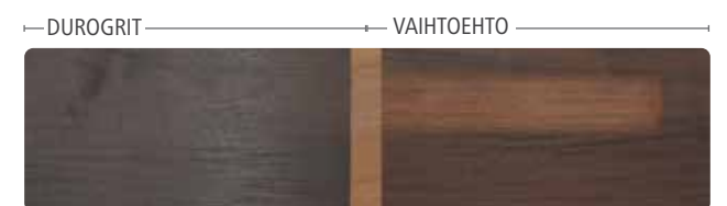
Puunäytteen tulos hankaustestin jälkeen . Kuten näet, paikka, jossa harja liikkui, on hyvin näkyvä vaihtoehtoisella tuotteella, kun taas DuroGritin kanssa sitä ei ole juuri lainkaan.
