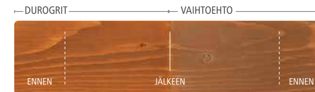
Väri Foxy Brown männyn UV-suojan osalta testattu 5 vuoden kuluttua verrattuna vaihtoehtoiseen tuotteeseen, jossa käytetään kaksikerroksista järjestelmää.
