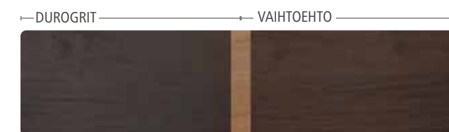
Puunäyte ennen hankaustestiä . Se käsiteltiin vasemmalla puolella DuroGrit-värillä Charred Black ja oikealla puolella vaihtoehtoisella tuotteella, jolla on samanlainen väri.
