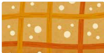
Nämä kuidut muodostavat ruudukon, johon mahtuu suuri määrä UV-stabilisaattoreita.
