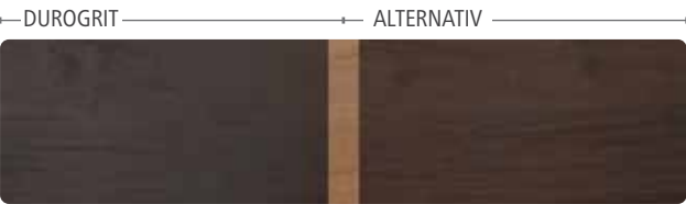
Træprøven inden skuretesten . Den blev til venstre behandlet med DuroGrit i farven Charred Black og til højre blev der påført et andet produkt i en lignende farve.
