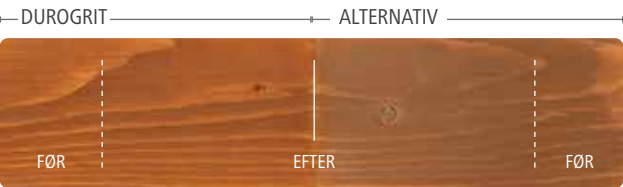
Farven Foxy Brown på fyr testet for UV-beskyttelse efter 5 år op mod et andet produkt, der baserer på et tolagssystem.
