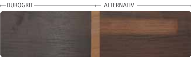
Resultatet af træprøven efter skuretesten . Det ses tydeligt, hvor børsten har været i gang med det andet produkt, mens stedet behandlet med DuroGrit er nærmest uændret.
