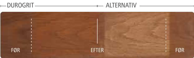
Farven Foxy Brown på teak testet for UV-beskyttelse efter 5 år op mod et andet produkt, der baserer på et tolagssystem.
