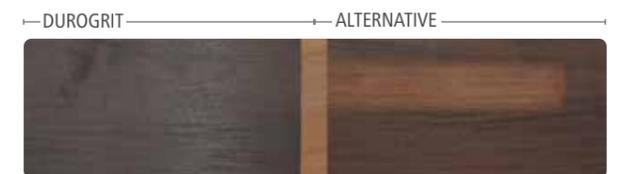
Das Ergebnis der Holzprobe nach dem Schrubbttest. Die Stelle, an der die Bürste über das Holz schrubhte, ist beim Alternativprodukt deutlich sichtbar. Bei DuroGrit ist sie kaum erkennbar.
