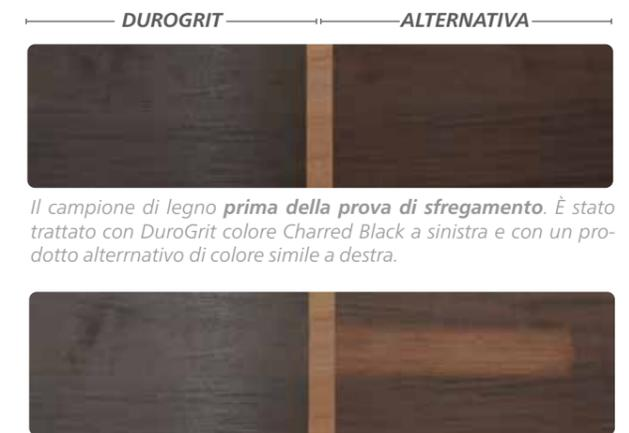
Il campione di legno **prima della prova di sfregamento**. È stato trattato con DuroGrit colore Charred Black a sinistra e con un prodotto alternativo di colore simile a destra.
