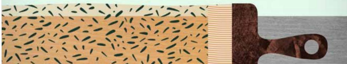
Il prodotto è costituito in parte da lunghe fibre di cellulosa del legno.
