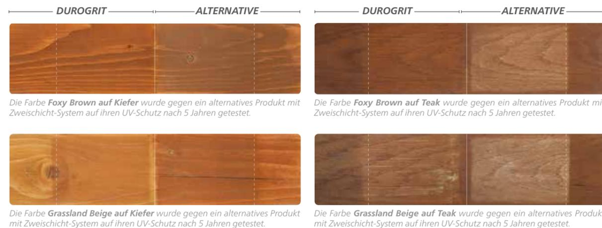
Die linke Hälfte des Holzbretts haben wir mit einer Schicht der DuroGrit-Farbe behandelt, die rechte Hälfte mit einem Wettbewerbsprodukt mit Zweischicht-System. Wie zu erkennen haben wir Farben gewählt, die unseren DuroGrit-Farben ähnlich sind, um ein möglichst getreues Ergebnis zu erzielen. Anschließend haben wir die Bretter in das QUV-Prüfgerät gelegt und die Ergebnisse nach 5 Jahren Witterungseinflüssen simuliert.
